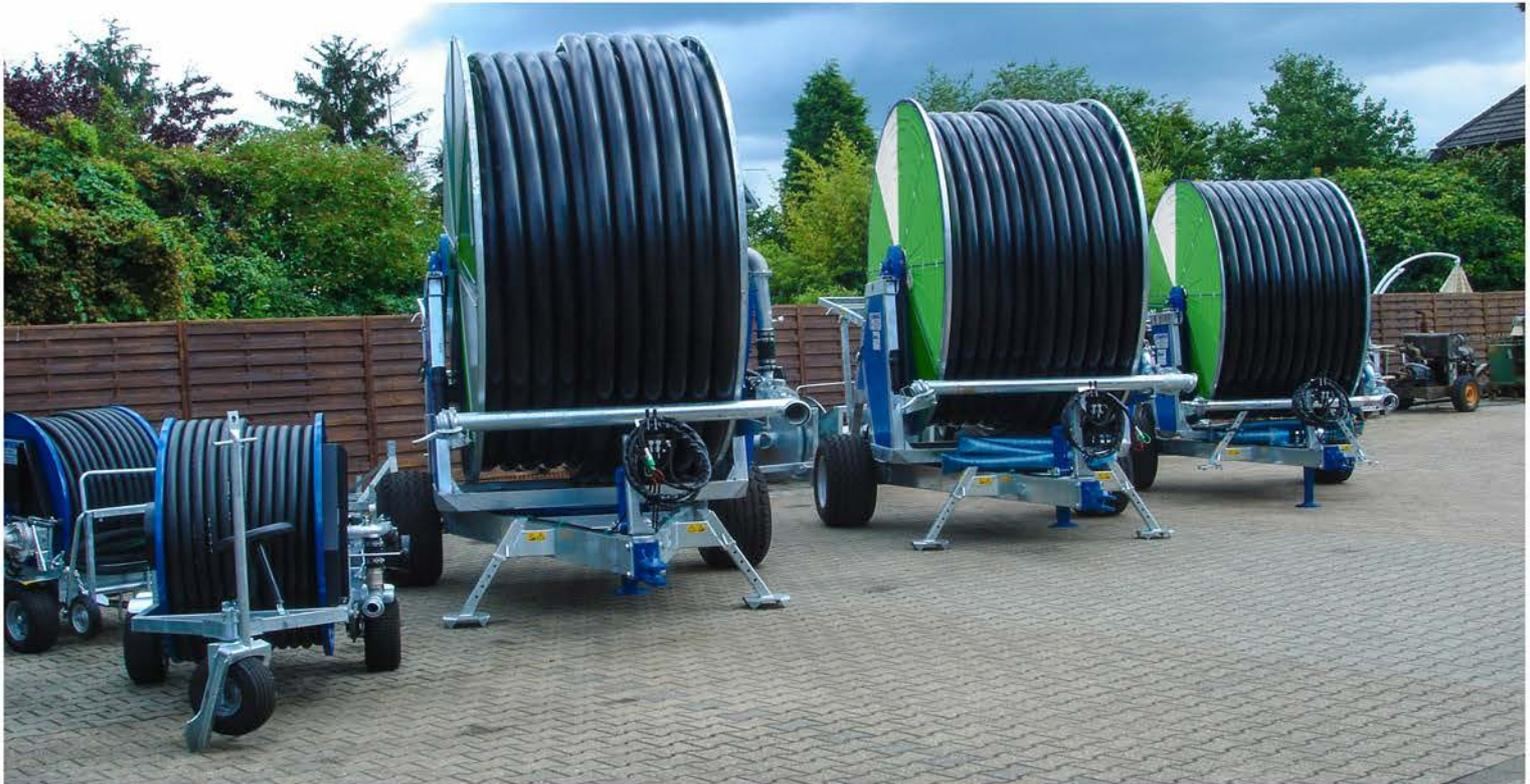
Se dispone de una amplia gama de diámetros (40-140mm) y longitudes de tubo de PE (100-750m) según las necesidades.
